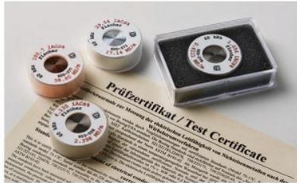
认证标准块用于 SIGMASCOPE® SMP350, 可追溯到国际认可的校准规范
